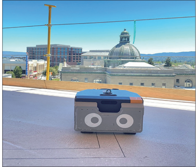
그림 1. Dusty FieldPrinter는 사람보다 5배 더 빠르고 정확도는 1/16인치 이내이다. (출처: Dusty Robotics)
