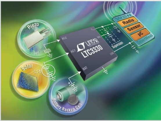
그림 4. LTC3330 에너지 포집 DC/DC 배터리 수명 연장 디바이스는 압전, 태양광, 자기 소스로부터 에너지를 포집 할 수 있다.
